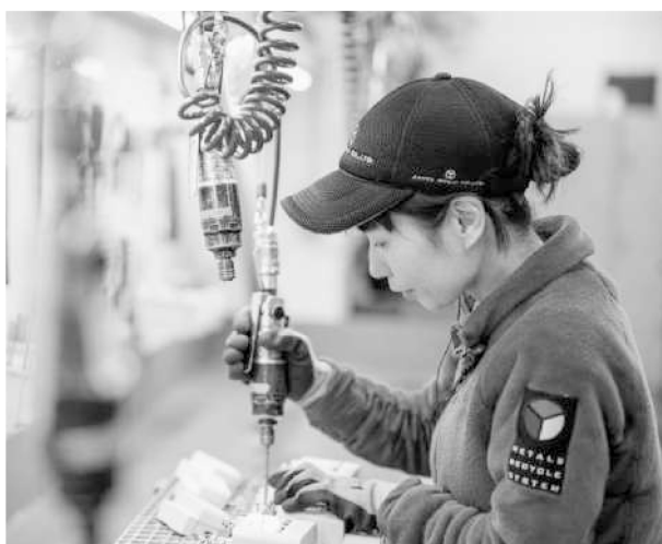
通信機器・設備を手作業で分解する
