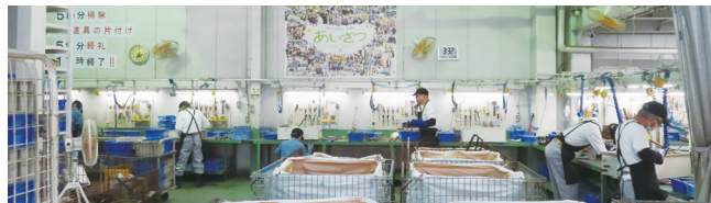
(上写真) 大阪リサイクルセンターの作業風景。情報機器等は機械処理を施しつつも破碎を行わずに、手作業による精査解体で素材回収率を向上させている
